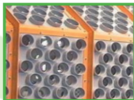
Tôles de criblage avec tubes anti-enroulement
