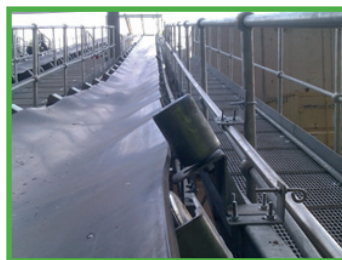
Convoyeur de transfert sur longueur > 40 m • Chariot déverseur
